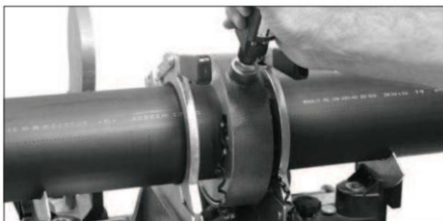
Srovnání konců potrubí integrovaným hoblíkem
