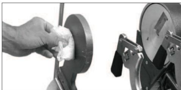
Čištění svařovacího zrcadla. Dbejte na to, aby nedošlo k poškození teflonové vrstvy
